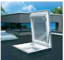
DRC – окно-люк с куполом, оборудованный антивандальным стеклопакетом P2. Купол может быть прозрачным или матовым. Окна 90x90 и 100x100 см открываются на угол до 80°, в размерах 90x120 и 120x120 см – до 60°. Газовые амортизаторы облегчают управление творкой и удерживают её в зафиксированном положении.
