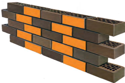
2 ЛОЖКОВАЯ КЛАДКА СМЕЩЕНИЕ НА 1/2 КИРПИЧА
