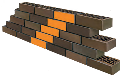
3 ЛОЖКОВАЯ КЛАДКА КОСОЕ СМЕЩЕНИЕ НА 1/4 КИРПИЧА
