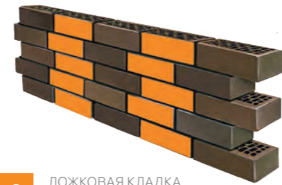
3 ЛОЖКОВАЯ КЛАДКА СМЕЩЕНИЕ НА 1/4 КИРПИЧА
