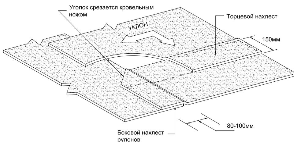
После удаления посыпки и подрезки уголка на место формирования торцевого нахлеста наносят слой мастики приклеивающей ТЕХНОНИКОЛЬ №22 (Вишера).
