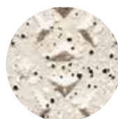
Поверхность с фактурными выступами «звездочки» (R 12-V4/B)
