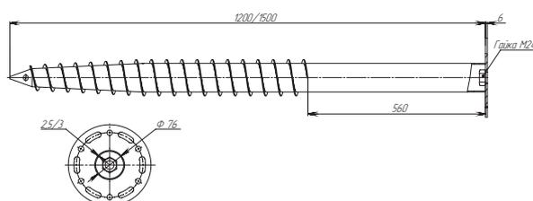
Винтовая опора на фланце 1,2 м, 1,5 м
